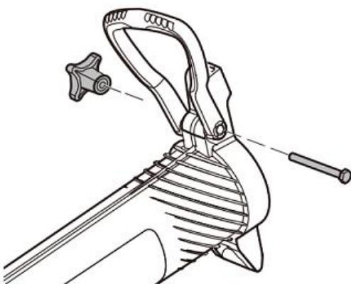
4. Чтобы отрегулировать угол наклона вспомогательной ручки, ослабьте ручку-зажим и надежно затяните ее после достижения нужного угла.
