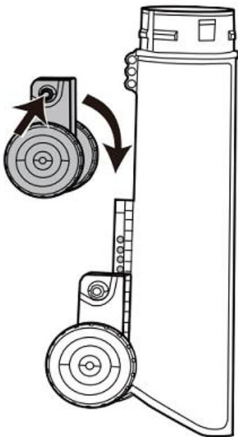
3. Вставьте фиксатор в верхней части трубы пылесоса в выемку в основании устройства.
