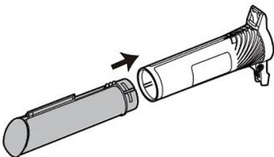
2. Прикрепите вспомогательную ручку к соответствующему круглому отверстию на верхней трубе пылесоса.
