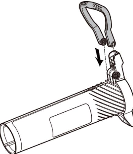
3. Вставьте болт через отверстие так, чтобы он прошел через обе стороны вспомогательной ручки, и закрепите с помощью ручки-зажима.
