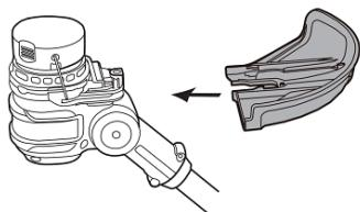
Установите ролики кромкореза
